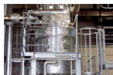
図6/淡水化プラント(フラッシュ蒸発)
